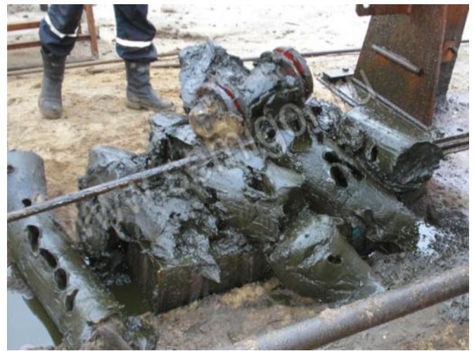
Камера очищена полностью, «трудяга» очистной поршень вынес 250 литров АСПО.
