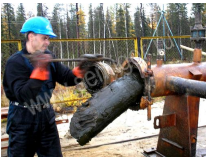
Продолжается выемка отложений из камеры приема.
